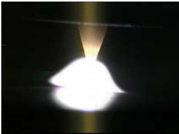
Bild 4 Lichtbogausbildung beim WIG- Impulsschweißen mit höheren Frequenzen
