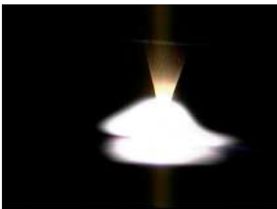
Bild 5 Lichtbogausbildung beim ungepulsten WIG- Schweißen
