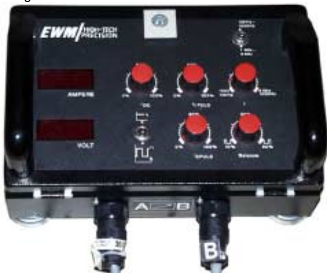
Bild 9 Fernsteller zum hochfrequenten WIG- Impulsstromschweißen, Bedienelemente
