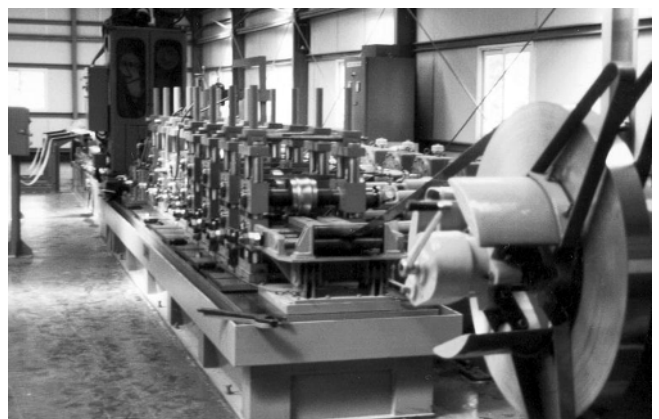
Bild 7 Versuchsanlage zur Herstellung längsnahtgeschweißter Edelstahlrohre
