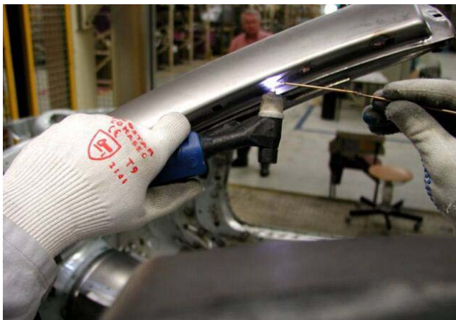
Bild 9 Manuelles Plasmalöten am Türrahmen einer BMW-PKW-Karosserie
