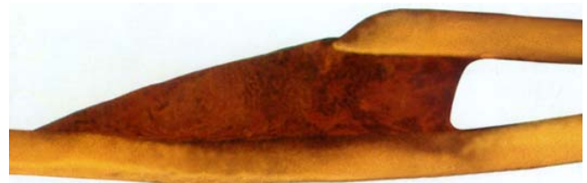
Bild 3 MIG-Lötstelle mit Aufschmelzung von Grundwerkstoff
