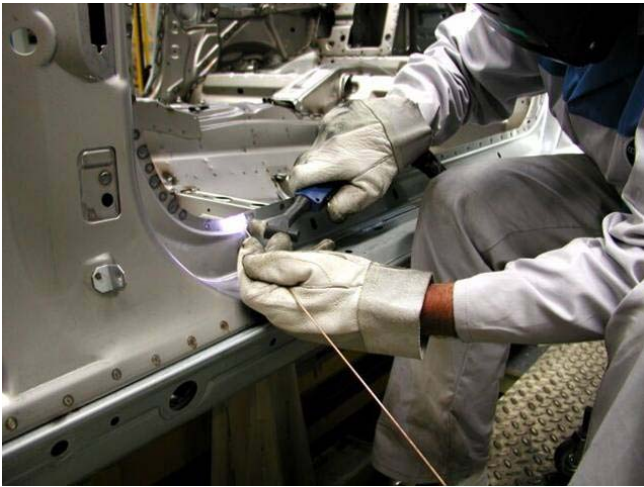
Bild 8 Manuelles Plasmalöten am Türschweller einer BMW-PKW-Karosserie
